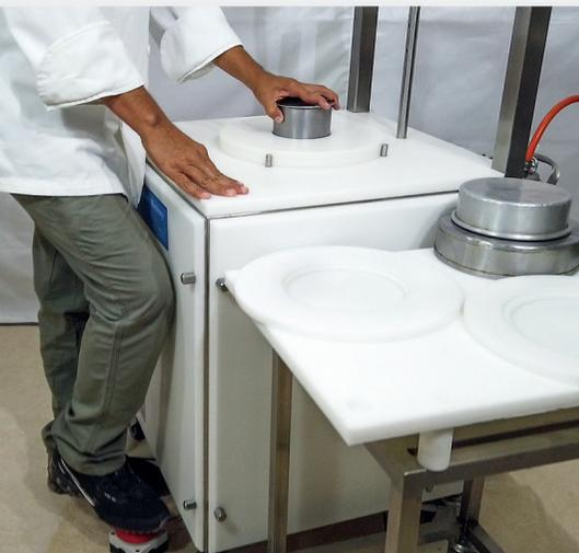
Máquina automática para aplicar antiadherente hasta para 10 moldes por minuto.
